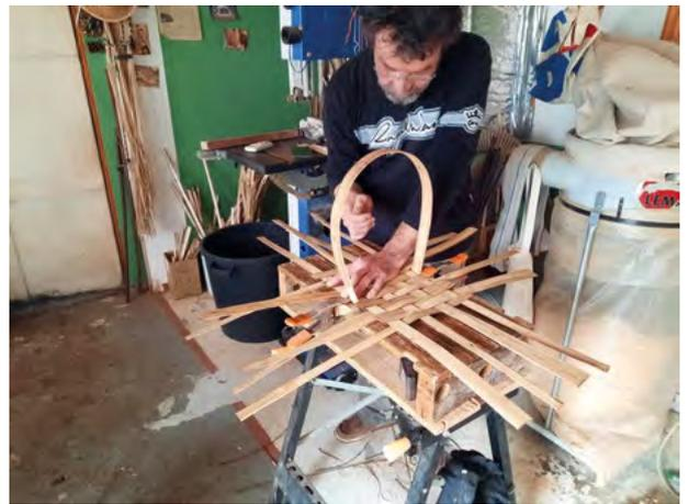
Les éclisses de largeur sont passées dessus-dessous de celles de la longueur, d'égale distance de part et d'autre de l'éclisse centrale. L'ensemble des lattes est régulièrement resserré pour éviter du jeu entre elles.
