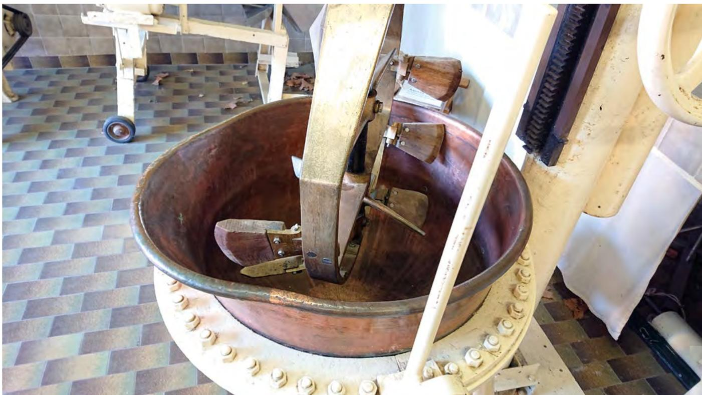
Un ensemble exceptionnel de machines en cuivre. Par exemple, ci-dessus, un détail d'un cuiseur batteur mélangeur, de la marque Ratti, avec son batteur mélangeur rotatif en bois et laiton et sa cuve à bec verseur en cuivre (IM83000080).
