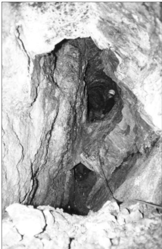
1. Dépilage réalisé au pic dans les niveaux supérieurs du filon n° 1 de la mine de Vallauray.
